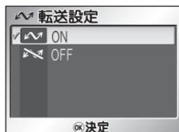
PictureProject がインストールされたパソコンとカメラを付属のUSBケーブルUC-E6で接続して、カメラの(OK) (転送) ボタンで画像を転送すると、転送設定された画像がパソコンに転送されます。セットアップメニューの「転送設定」が「ON」の場合は、撮影する画像すべてが転送設定されます。
