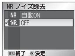
シャッタースピードが低速になると、画像にノイズが入る場合があります。暗いところなどで撮影する場合、「ノイズ除去」を「自動 ON」に設定すると、このノイズを軽減させることができます。「自動 ON」または「OFF」を選択して
